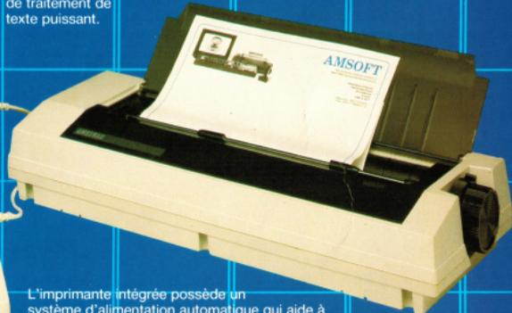
L'imprimante intégrée possède un système d'alimentation automatique qui aide à bien positionner les feuilles, et un rouleau d'entraînement pour le papier en continu.
