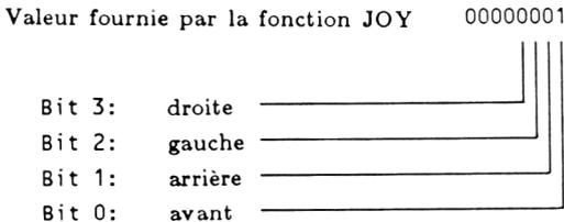
Il est aisé de passer de l'interrogation du joystick à son application dans la programmation graphique. C'est ainsi que le joystick permet aisément de déplacer une marque, appelons-la curseur joystick, sur l'écran. Le curseur joystick peut être utilisé dans la programmation d'un programme de dessin pour marquer l'endroit où est situé le pinceau ou le crayon à dessin.
