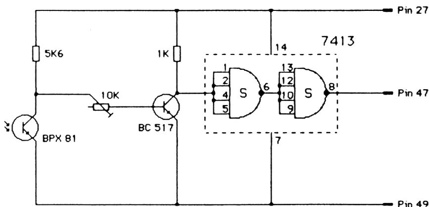
**Figure 18 :** Le schéma du circuit du crayon optique
