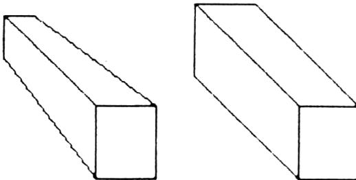
Figure 17 :     **Objet avec lignes cachées : à droite perspective parallèle, à gauche perspective centrale**
