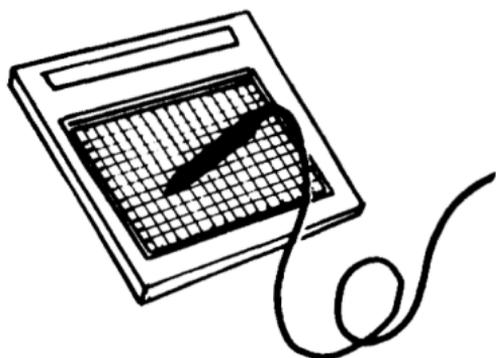
Il s'agit d'une plaque sur laquelle vous dessinez à l'aide d'un crayon, d'un stylet, d'un bras articulé ou même du doigt. Chaque position d'écriture est convertie en données grâce à un dispositif électronique (compteur optique, rhéostat, coupleur magnétique...).
