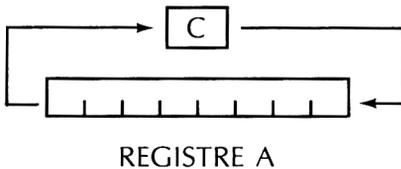
Tous les bits de l'accumulateur subissent un décalage vers la gauche ; le bit contenu dans l'indicateur de retenue passe dans le bit 0 et c'est le bit 7 qui prend sa place. Il s'agit donc là d'une rotation réalisée sur 9 bits.
