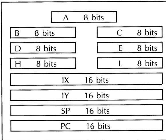
Les registres sont identifiables à des cases mémoire par lesquelles l'information va transiter. Le microprocesseur Z80 contient des registres 8 bits et des registres 16 bits. Les instructions BASIC ne permettent pas l'accès à ces registres et nous ne pourrons jamais, avec la fonction PEEK par exemple, savoir ce que contient tel ou tel registre.
