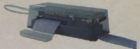
Le module X (version RS) et le contrôleur de disquette 3" d'Amstrad
