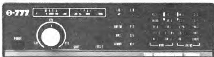
**TONO - 777.** Convertisseur entièrement automatique émission-réception en CW, RTTY (Baudot et ASCII) et AMTOR (ARQ/FEC/SEL-FEC). Reprend les caractéristiques des convertisseurs TONO + interface RS 232C niveau TTL pour micro-ordinateur.
