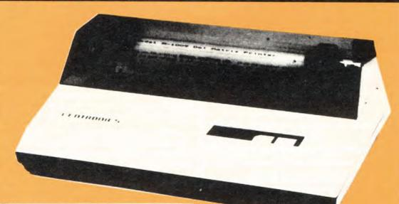
sette, couleur, noir - Dimensions 333(L) x 190(P) x 70(H) mm - Poids : 3 kg - Température : 5°C à 35°C - Humidité : 20 à 80 % - Niveau bruit : moins de 60dB en fonctionnement - Alimentation : 117, 220 ou 240V - Consommation : 30 VA - Interface standard parallèle 8 bits - Fonctions diverses : detection positionnement, detection fin de papier, auto-impression, mise en réserve hexadécimale.
