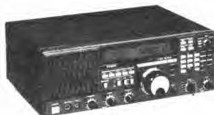
**FRG 8800.** Récepteur à couverture générale de 150 kHz à 30 MHz. Tous modes. Interface de commande par ordinateur. Convertisseur VHF 118 à 174 MHz en option.
