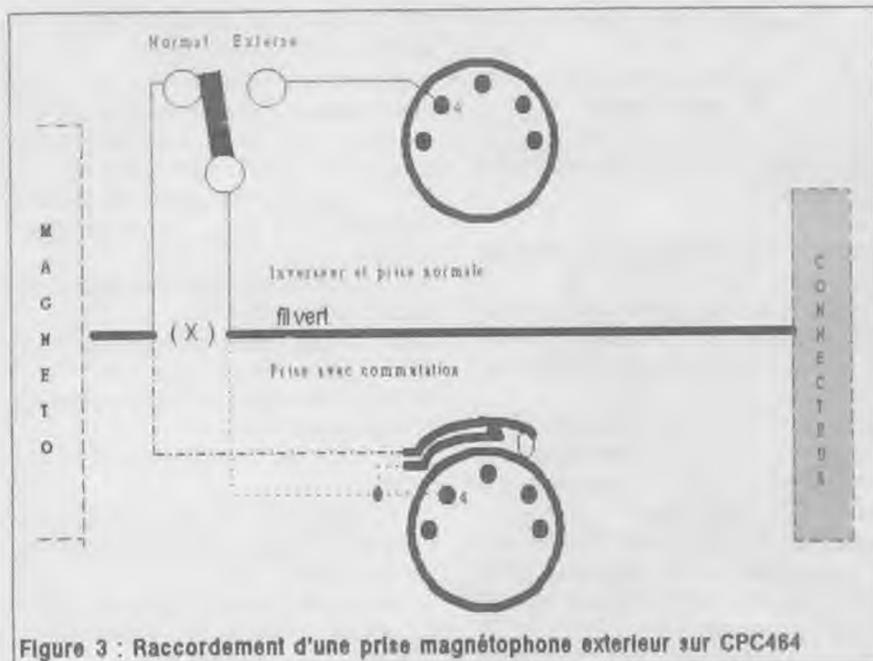
Figure 3 : Raccordement d'une prise magnétophone extérieur sur CPC464
