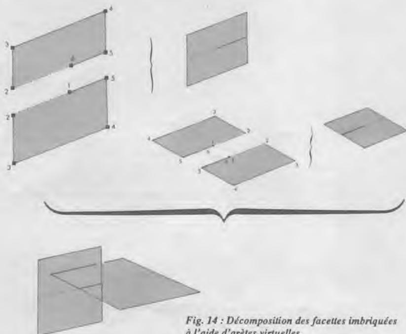
Fig. 14 : Décomposition des facettes imbriquées à l'aide d'arêtes virtuelles.
